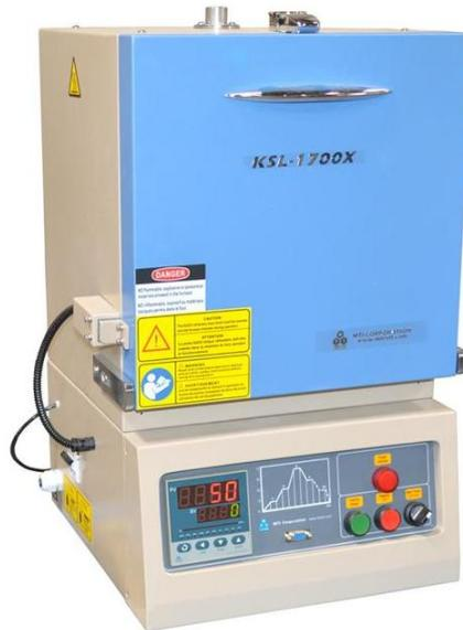
KSL-1700X-S 是一款高温箱式炉，以硅钼棒为加热元件，采用双层壳体结构和 PID 程序控温，B 型热电偶，炉膛采用高纯氧化铝纤维材料，最高温度能达到 1700 度，可连续工作温度 1600 度，控温精度±1 度，该炉具有温场均匀、表面温度低，节能等优点，是高校、科研院所、工矿企业做高温烧结，金属退火、质量检测用的理想产品。
