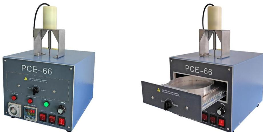
PCE-66 是一款小型紫外臭氧清洗机，可用于清洗各种单晶基片，以保证更好的成膜质量。同时也可去除光刻胶、改善材料表面润湿性、清洗 SEM 和 TEM 样品及紫外活化聚合物等。内置加热管，可加热基片，最高加热温度 150℃，PID 方式控温，可设置 30 段升降温程序。带有搅拌功能，用作氧化物包括干法电极电池正极材料的表面处理。
