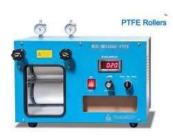
MSK-MR100DC 是一款小型电动辊轧机,采用 24V 直流电机驱动,可在 Ar 环境下的手套箱内使用,轧辊储存为 $\Phi$ 100×100mm。此款设备特别适合电池电极的制作,在电极涂布和烘干后进行轧制。
