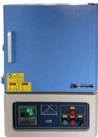
KSL-1800X-A1 是一款 1800℃ 高温箱式炉，炉膛采用高纯氧化铝纤维保温材料，加热元件为 1900℃ 级硅钼棒，采用高精度进口欧陆仪表和高精度 SCR 电力调整器用于温度显示和温度控制，多段可编程控制器和 PID 程序控温，控温精度  $\pm 0.1^{\circ}\text{C}$ ，采用双层壳体结构。该炉具有温场均匀性高、表面温度低、安全度高、高效节能、稳定性高、使用寿命长等优点。广泛应用于高等院校、科研院所及企业对金属、非金属及其化合物，陶瓷材料、复合材料等材料进行烧结、退火、热分析、热处理等等工艺。
