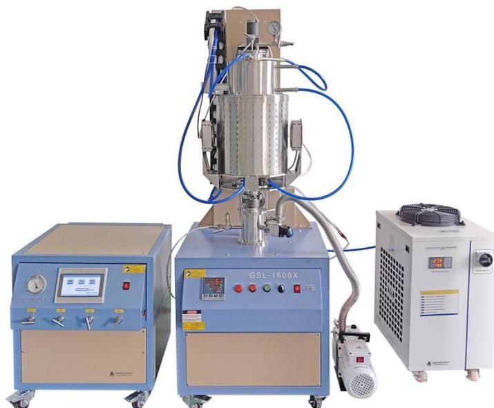
GSL-1600X 是一款小型的顶吹氢气还原系统，最高温度可达 1600℃，上法兰上的一个  $\phi 6.35\text{mm}$  的卡套接头为进气口，在法兰内部安装了一根进气管，进气管延伸到样品坩埚的位置，且炉体固定在背面的移动机构上，由控制面板上的升降转换旋钮控制其自动上升或下降，方便取料与放料，可用于小样品的烧结与退火，是一款经济、实用型设备。
