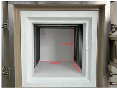
KSL-1600X-H5E 是一款经济型箱式炉，可在氢气或惰性气氛下进行材料合成，最高温度可达 1700°C。炉膛材料采用高纯氧化铝纤维砖，加热元件为钼丝，加热腔体尺寸：16 “x16” x16 “。带有真空密封设计的炉门，配有水冷夹层和氢气尾气自动燃烧处理系统。此款设备特别适用于在还原气氛或氩气环境下对材料进行热处理。（图片仅供参考，以实物为准）
