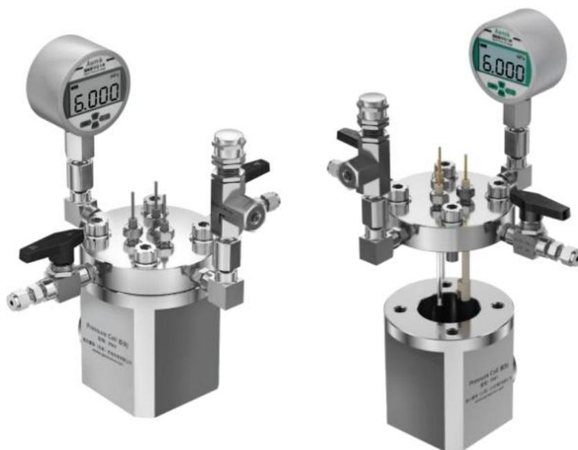
HPE-SC 是用于基础电学研究的高压 (6 MPa) 单腔三电极电解槽。
